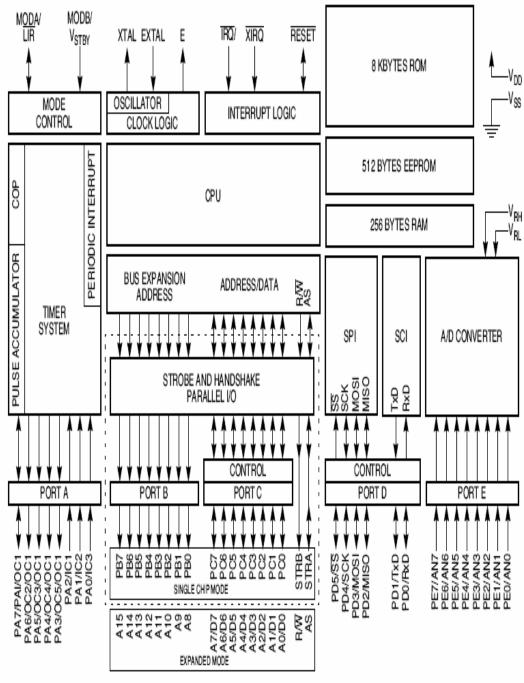
CIRCUITRY ENCLOSED BY DOTTED LINE IS EQUIVALENT TO MC68HC24.
