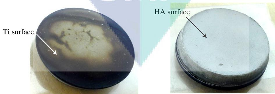
(d) N<sub>2</sub>+H<sub>2</sub> gas atmosphere (sintered using the diffusion furnace)
