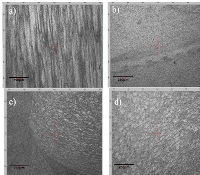
**Figure 6.** Microstructure for DSP sample (a) BM, (b) WZ, (c) TMAZ and (d) HAZ.
