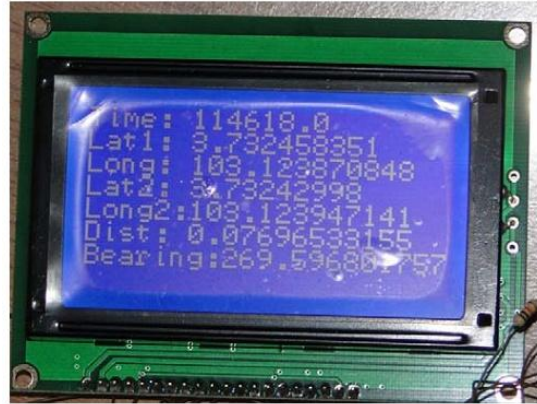
Fig. 8 Screenshot of GLCD showing latitude and longitude coordinates of Remote Unit
