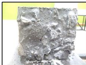
(d) The crack patterns cube sample of 7.5% for 14 days
