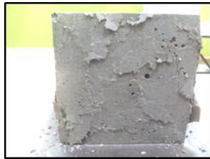
(d) The crack patterns cube sample of 7.5% for 28 days
