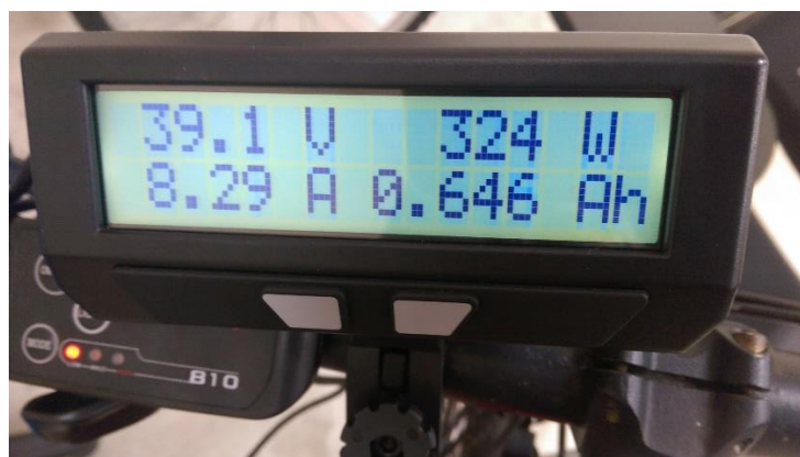
Figure 4.2. Electrical parameter display
