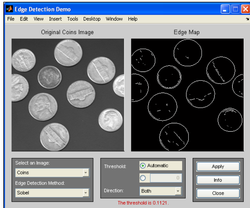
Figure 2.6 : Sobel Edge Detection
