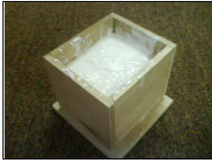
Figure 3.12: Pour in RTV-2 silicone rubber
