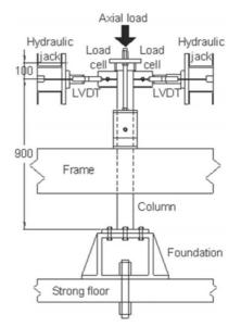
(d) Schematic diagram of test setup with axial load
