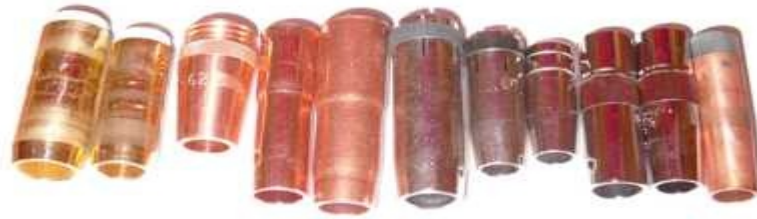
Figure 2.9: Welding Nozzle (Kang SK, 2005)
