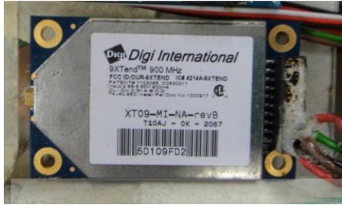
Figure 3-15 The DS-XTend RF module
