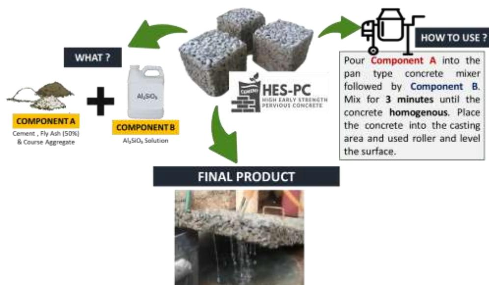
“Komponen A adalah terdiri daripada simen, 50 peratus abu terbang dan agregat kasar, manakala komponen B terdiri daripada larutan Al<sub>2</sub>SiO<sub>5</sub>.
