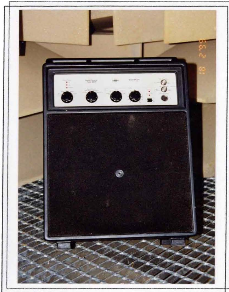
Foto K : Sumber Bunyi Model Brüel & Kjær Type 4224
