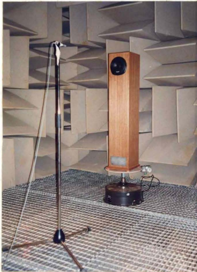
Rajah 4.6: Kedudukan pembesar suara semasa ujian sambutan frekuensi dan pola pengarahannya
