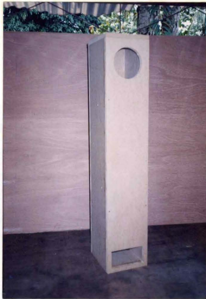
Rajah 3.22: Bentuk asas pengepong yang telah siap
