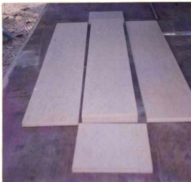
Rajah 3.13: Bahagian pengepong yang telah dipotong
