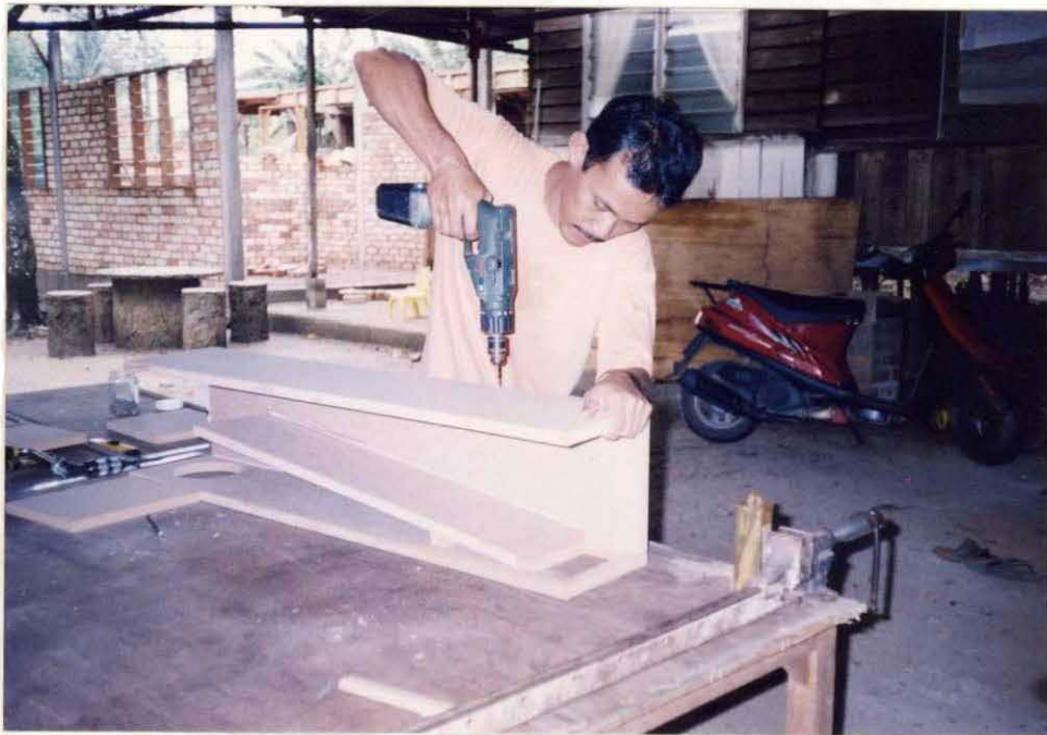
Rajah 3.18: Kerja-kerja pemasangan skru di bahagian cantuman
