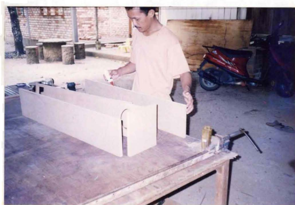
Rajah 3.17: Kerja-kerja sapuan gam untuk cantuman
