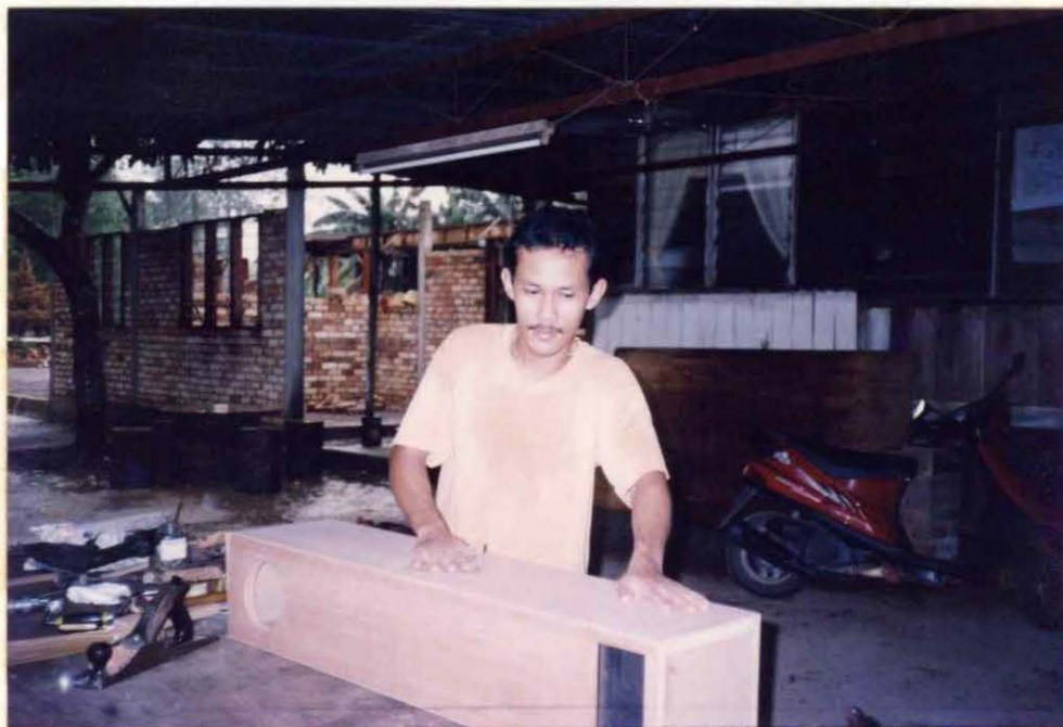
Rajah 3.25: Kerja-kerja menggosok permukaan menggunakan kertas pasir
