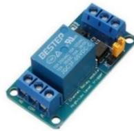
Figure 3.7: Relay Module
