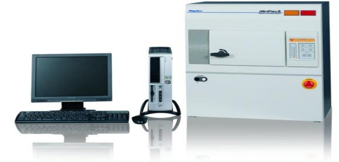
**Figure 3.7:** XRD Miniflex (Rigaku)
