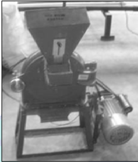
Gambar 3.5: Mesin Pengisar (Disk Mill FFC-45A, China)
