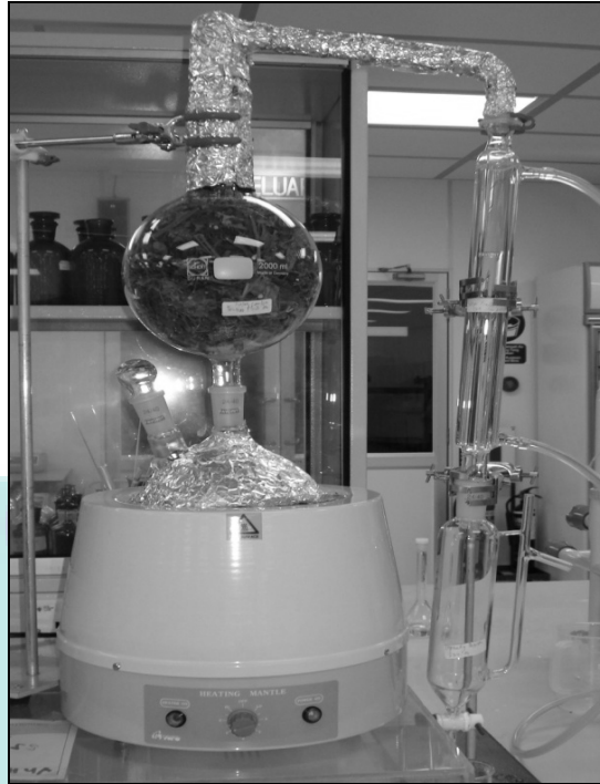
Gambar 3.7: Radas penyulingan stim
