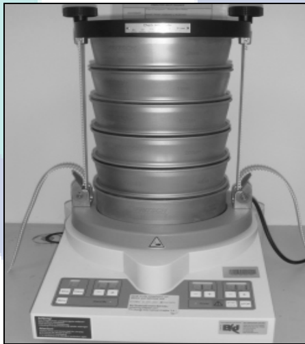
Gambar 3.6: Mesin Pengayak Bergetar (FRITSCH, Idor-Oberstein)
