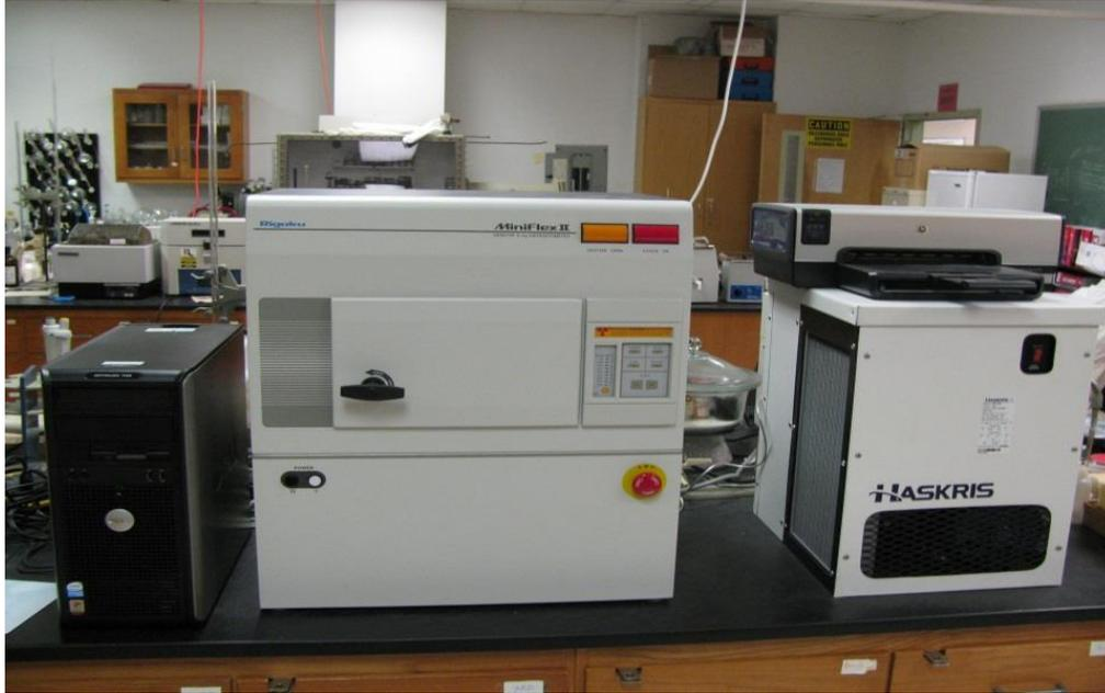
**Figure 3.1:** Rigaku Miniflex II XRD
