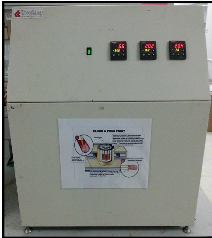
Appendix A.9.3: K46100 Cloud Point & Pour Point Apparatus
